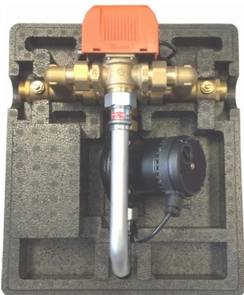
In Verbindung mit dem SHR-Regler wird über das SULM die überschüssige Wärme aus dem Führungsspeicher in den oder die Erweiterungsspeicher umgeladen. Bei diesem Umladevorgang werden vom SHR-Regler die Pumpe u. das Entladungsventil eingeschaltet. Die Wärme wird am Führungsspeicher am Heißwasser-Anschluss [Platzierung abhängig vom Speichertyp] entnommen u. am Erweiterungsspeicher von oben nach unten eingeschichtet.
